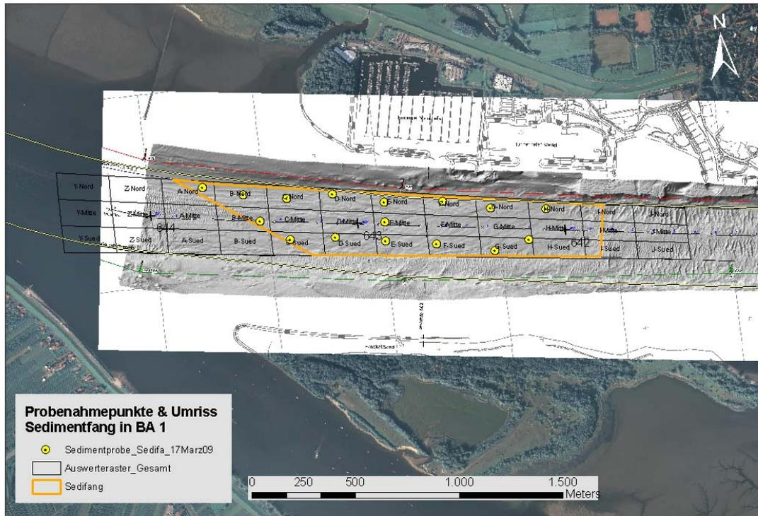
**Abbildung 2-1: Probenahmeraster und IST-Positionen am Beispiel der Probenahme am 17.03.2009 im Zuge einer Freigabeuntersuchung**
