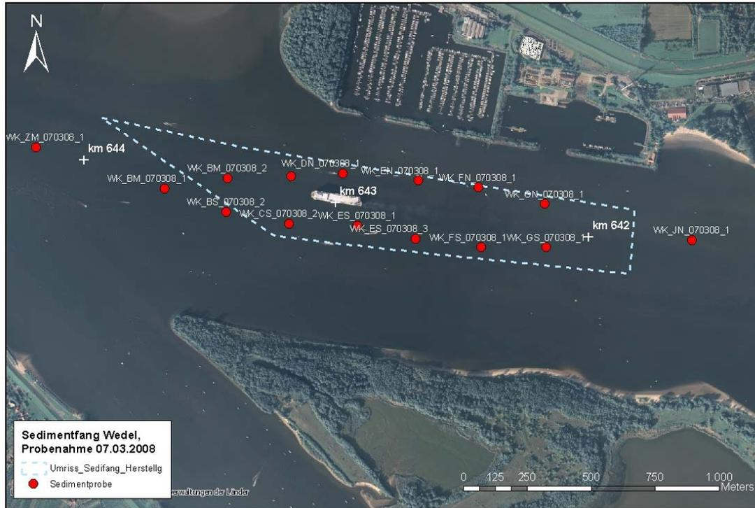
**Abbildung 2-1: Übersicht Probenahmepunkte bei Sedimentbeprobung am 07.03.2008**
