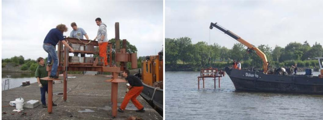
**Abbildung 4-3: Geräteträger und Bergung des Geräteträgers nach Einsatz im Sedimentfang (Photos HPA)**
