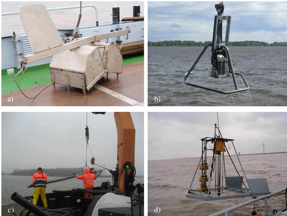
**Abbildung 3-2: Eingesetzte Probenahmeegerätschaften: a) van Veen Greifer, b) Kastengreifer, c) Kolbenlot und d) Vibrococer für die Entnahme von Sedimentkernen**
