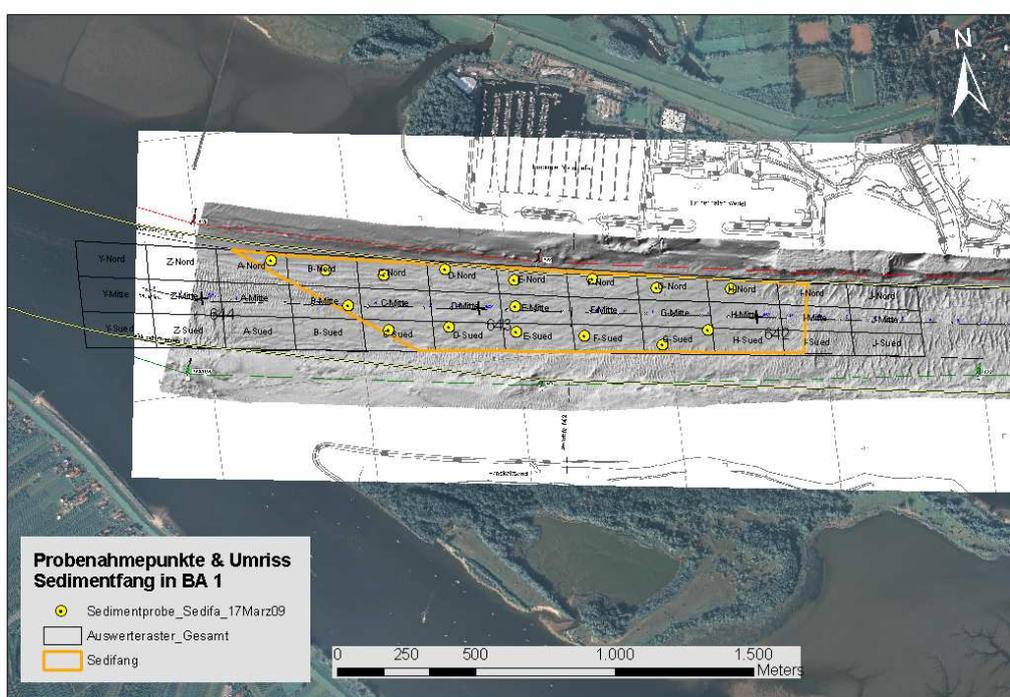
**Abbildung 3-3: Probenahmeraster und Positionen der Freigabeuntersuchung vom 17.03.2009, Sedimentfang vor Wedel in BA 1**
