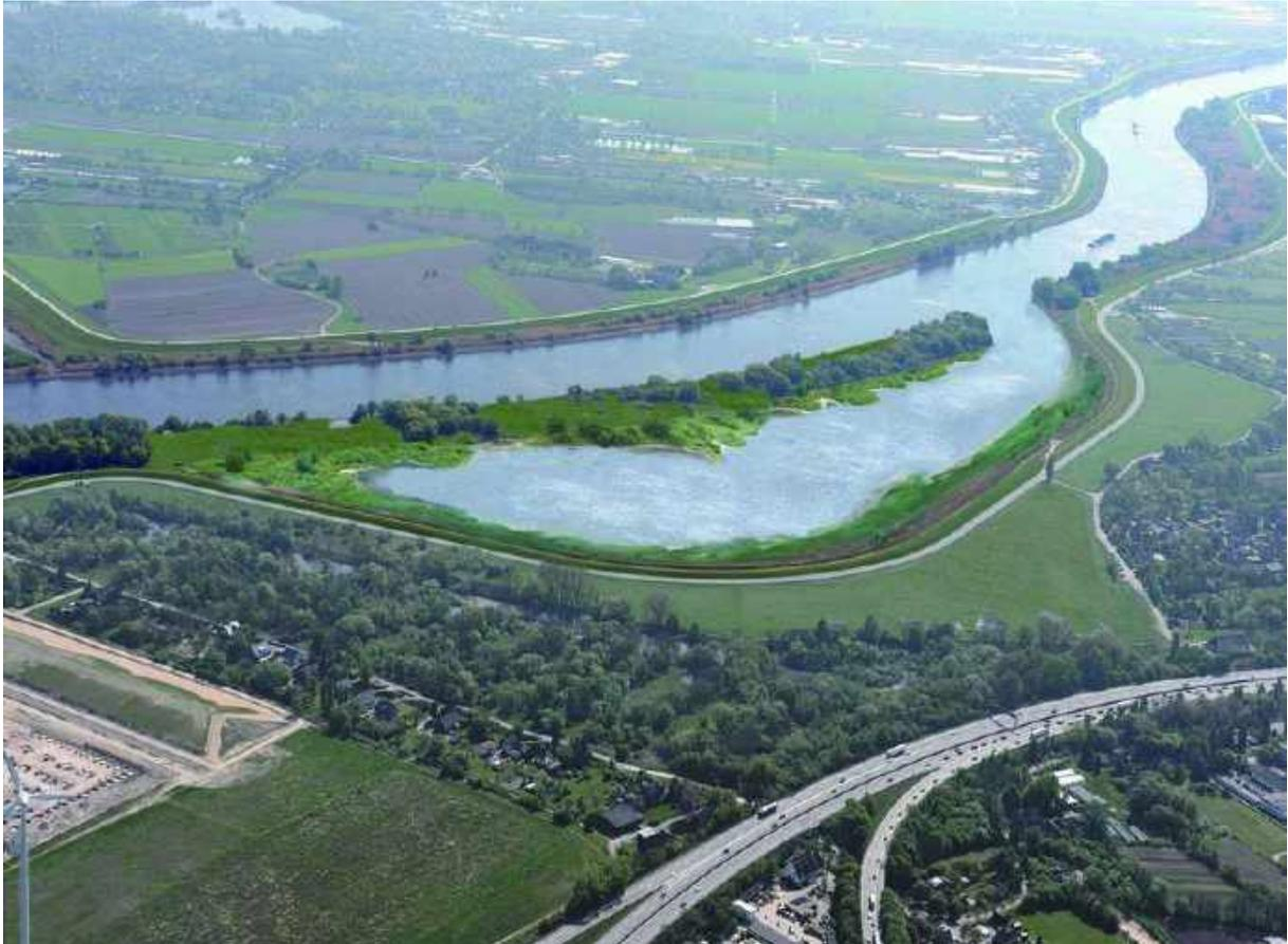
**Abbildung 8:** Pilotprojekt Kreeetsand der Hamburg Port Authority (HPA) - Schaffung von Flutraum zur Dissipation der Strömungsenergie (HPA 2013: 18)
