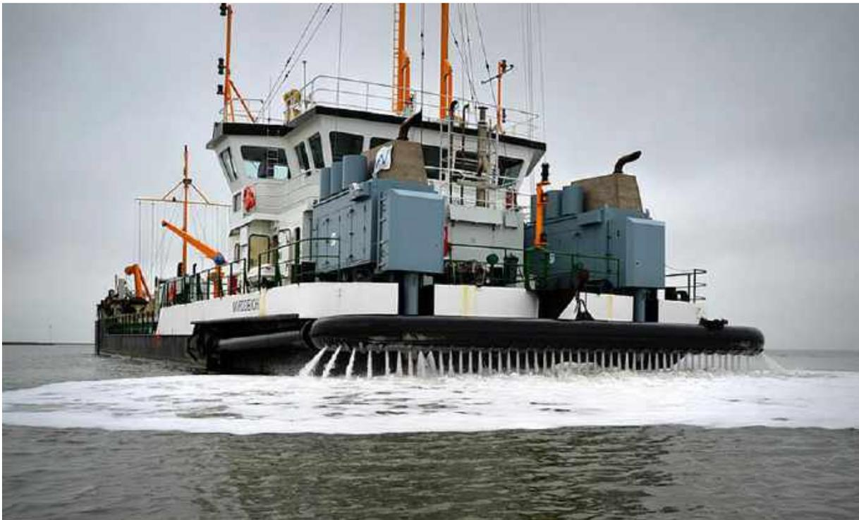
**Abbildung 29:** Arbeitsschiff „Seekrabbe“ mit einem Wasserinjektionsgerät, deutlich ersichtlich sind die Wasserstrahldüsen (Niedersachsen Ports GmbH & Co. KG. o.J.: o. S.)
