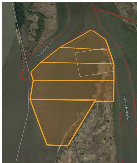
Abbildung 50: Für die Lidar-Messungen geplante Abschnitte des Wattgebietes vor dem Bishoster Sand (aufgrund der schwierigen Wetterbedingungen wurden am 08.11.2021 nur die beiden nördlichsten Abschnitte beflogen)
