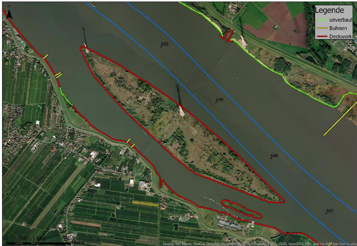
Abbildung 15: Aktueller Zustand der Ufer der Lühesander Süderelbe, einschließlich der Insel Lühesand und der Pionierinsel (Quelle: WSA Elbe-Nordsee (2021))
