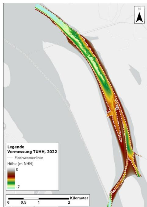
Abbildung 70 Digitales Geländemodell der Pagensander Nebenelbe, erzeugt auf Grundlage der Vermessung vom 13.05.-23.06.2022
