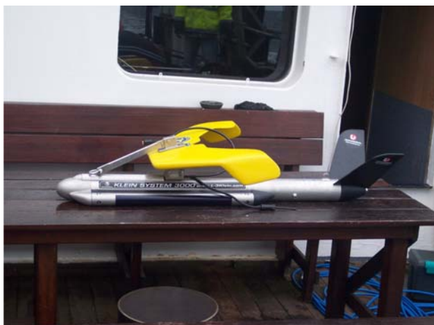
Abb. 3 Towfish „Klein 3900“ mit Depressure Vane
