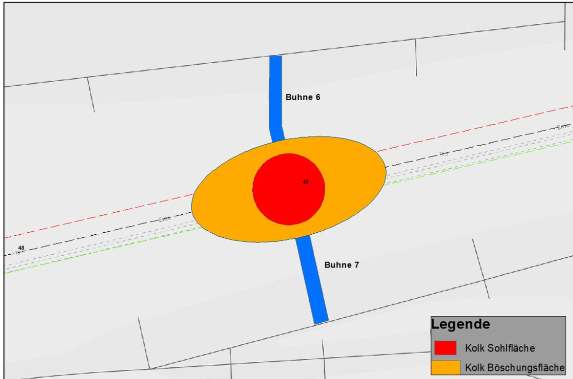
Abb. 4: Modellerte Auskolkung im Bereich der Querschnittseinengung bei Buhne 6 und 7.
