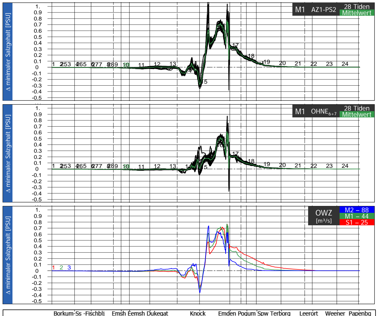
Bild 40: Ausbaubedingte Änderung des tiefengemittelten minimalen Salzgehalts in Fahrrinnenmitte zwischen Borkum und Papenburg. Oben für den häufigsten Oberwasserzufluss (M1) getrennt für alle 28 Tiden des Analysezeitraums (Schwarz) und die mittlere Änderung (Grün). Mitte für den Ausbauzustand ohne Berücksichtigung der geplanten Querschnittseinengung. Unten die mittlere Änderung für die drei untersuchten Szenarien M2 (mittlerer Oberwasserzufluss (OWZ), blau), M1 (häufigster OWZ, grün) und S1 (niedriger OWZ, rot)
