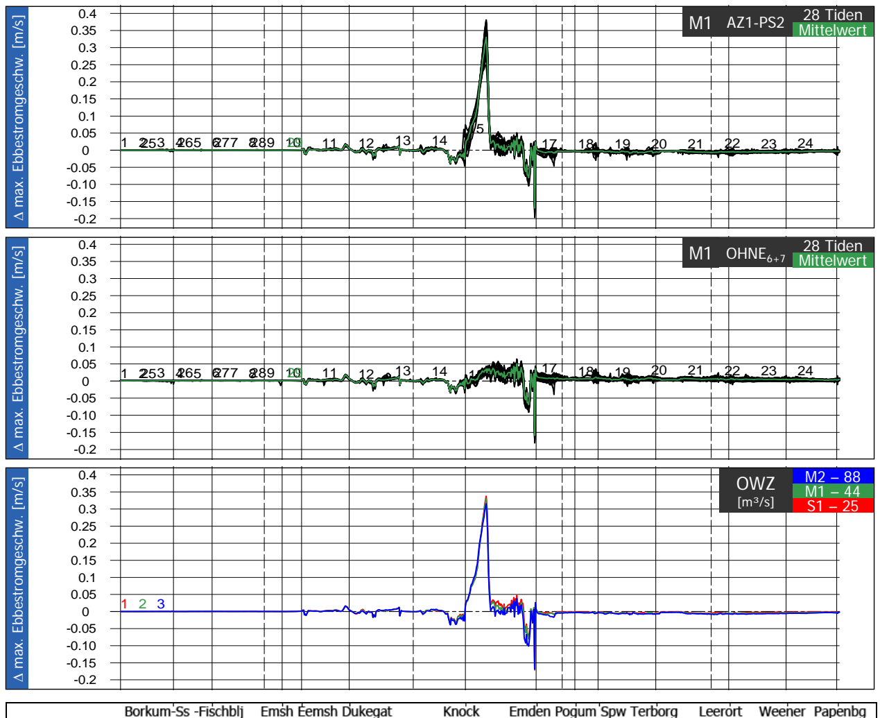
Bild 35: Ausbaubedingte Änderung der tiefengemittelten maximalen Ebbestromgeschwindigkeit in Fahrrinnenmitte zwischen Borkum und Papenburg. Oben für den häufigsten Oberwasserzufluss (M1) getrennt für alle 28 Tiden des Analysezeitraums (Schwarz) und die mittlere Änderung (Grün). Mitte für den Ausbauzustand ohne Berücksichtigung der geplanten Querschnittseinengung. Unten die mittlere Änderung für die drei untersuchten Szenarien M2 (mittlerer Oberwasserzufluss (OWZ), blau), M1 (häufigster OWZ, grün) und S1 (niedriger OWZ, rot)
