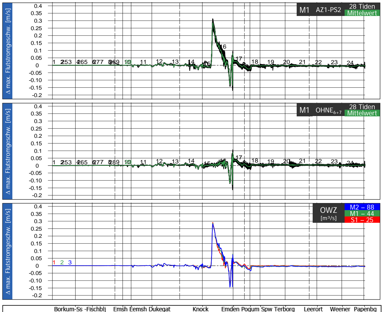
Bild 34: Ausbaubedingte Änderung der tiefengemittelten maximalen Flutstromgeschwindigkeit in Fahrrinnenmitte zwischen Borkum und Papenburg. Oben für den häufigsten Oberwasserzufluss (M1) getrennt für alle 28 Tiden des Analysezeitraums (Schwarz) und die mittlere Änderung (Grün). Mitte für den Ausbauzustand ohne Berücksichtigung der geplanten Querschnittseinengung. Unten die mittlere Änderung für die drei untersuchten Szenarien M2 (mittlerer Oberwasserzufluss (OWZ), blau), M1 (häufigster OWZ, grün) und S1 (niedriger OWZ, rot)
