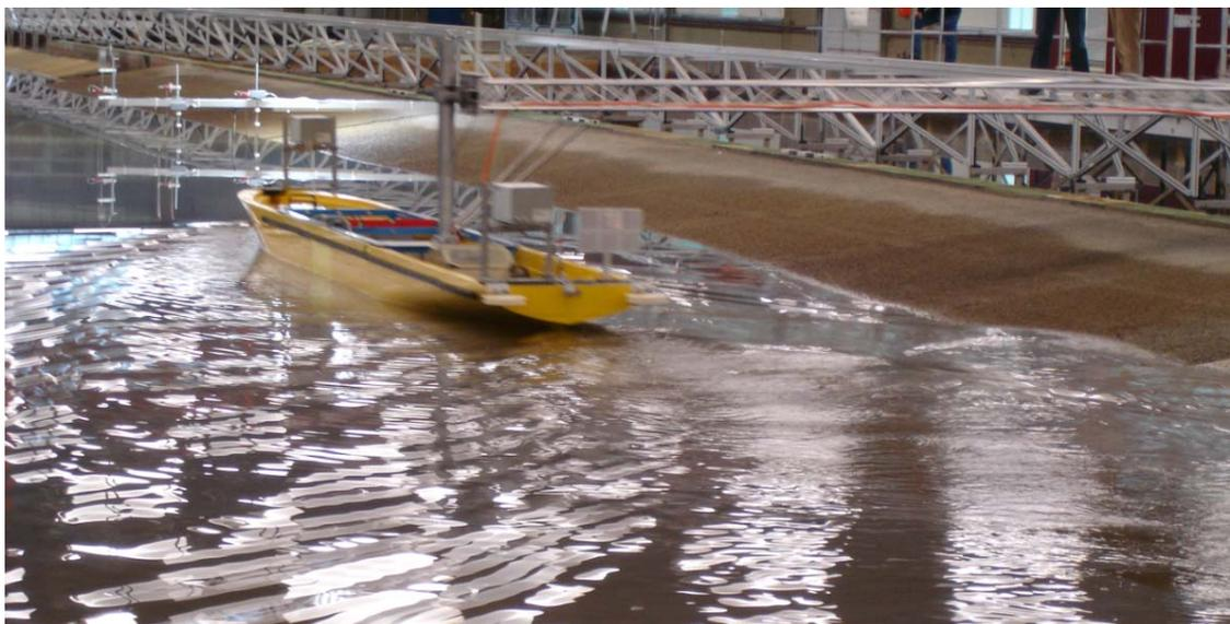
Bild 15: Autotransporter ( $c_B = 0,6$ ) und langperiodische Wasserspiegelauslenkung an einer 1:6 geneigten Böschung im Modellwellenbecken der BAW (Maßstab 1:40,  $v_S \approx 11,6$  kn)
