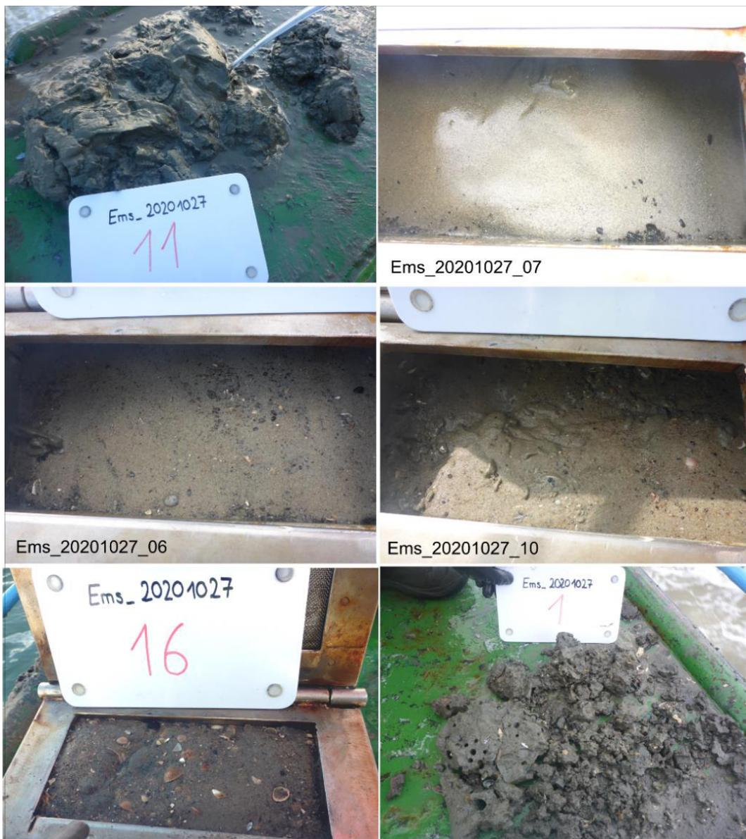
**Abb. 4:** Exemplarische Bilder der kartierten Sedimenttypen. Ems\_20201027\_11: Schlick und schlickiger Sand (MsM), Ems\_20201027\_07: Feinsand (mäßig bis gut sortiert), Ems\_20201027\_06 und Ems\_20201027\_10: Mittel- bis Grobsand (schlecht bis gut sortiert) mit Muscheln und Torfgeröll und -brocken, Ems\_20201027\_16: Grobsedimente mit Mittel- bis Grobsand (schlechtsortiert), Ems\_20201027\_01: Organischer Torf mit Bohrmuscheln und Holzresten.
