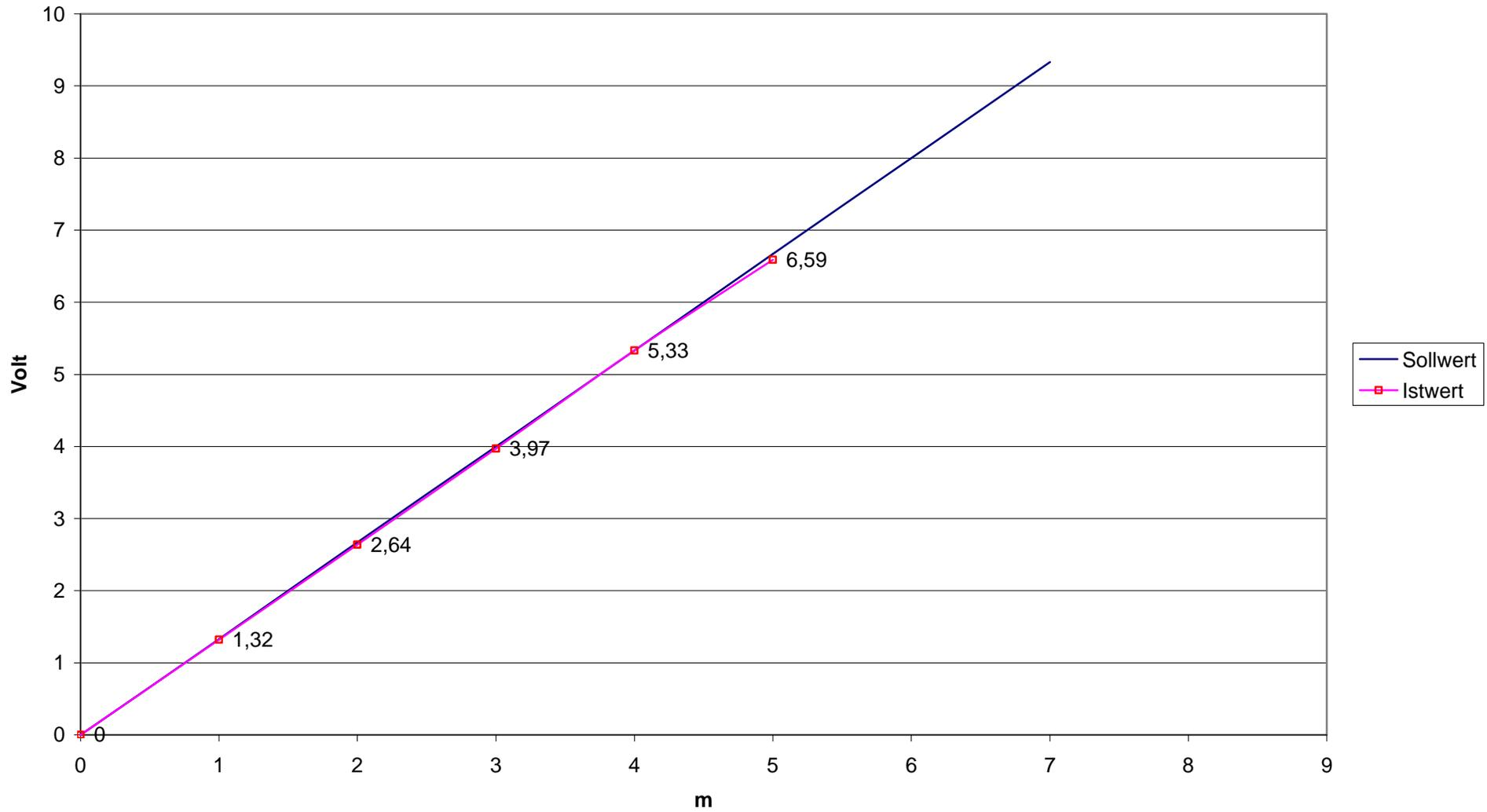
**Wellenmessdraht Kalibrierung Ems "Paapsand"**
