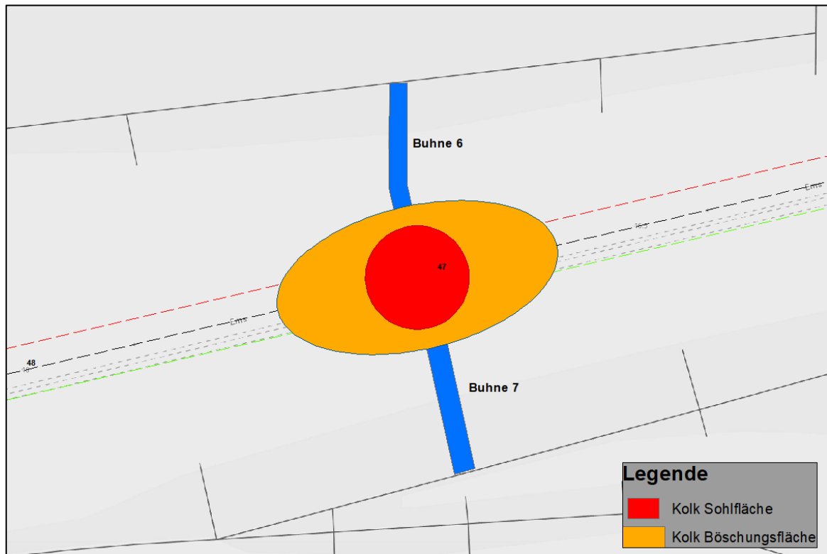
Abb. 5: Modellierter Auskolkung im Bereich der Querschnittseinengung bei Buhne 6 und 7.
